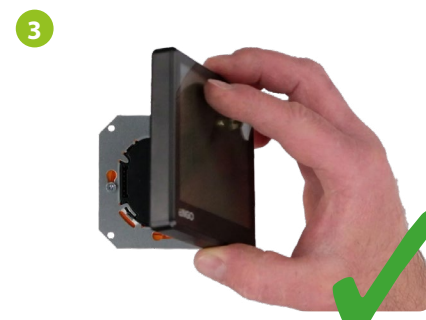
Nasun przód regulatora na jego tylną część. Włącz zasilanie. Regulator jest przygotowany do pracy.
