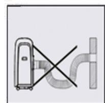
**Halten Sie den Luftschlauch so kurz und ohne Biegungen wie möglich, um die Engpässe zu vermeiden. Der Abluftschlauch soll nicht länger als 1,5 m sein.**
